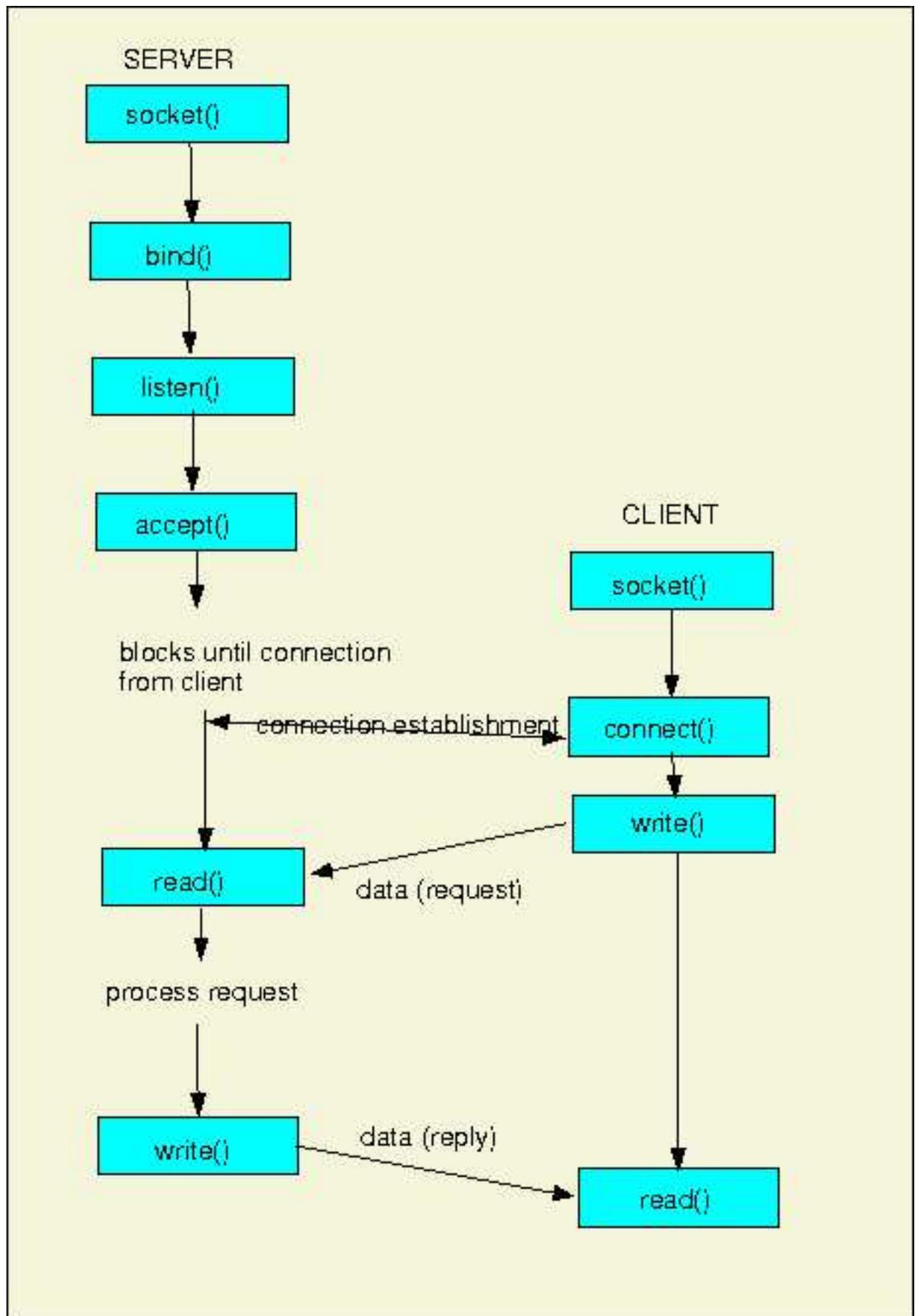
Zuerst wird beim Server mit `socket` ein handle erzeugt, welches mit `bind` an einen Netzwerkknoten angebunden wird. Mit `listen` wird eine Queue erzeugt, dann wartet der server mit `accept`. Der client erzeugt auch ein handle und kann dann mit `connect` an den server gehen. Die beiden handles, werden manchmal Übertragungsendpunkte genannt. Steht die Verbindung kann mit dem Systemaufruf `read/write` gearbeitet werden. `socket` erzeugt die Endpunkte und liefert file descriptoren:
